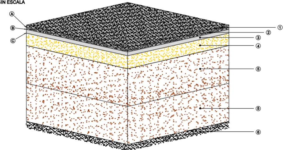
**DETALLE "2" SECCION TIPO PAQUETE DE FIRME EN CALZADA SIN ESCALA**
