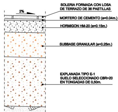
DETALLE "2" PERSPECTIVA DEL PAQUETE DE FIRME EN CALZADA SIN ESCALA
