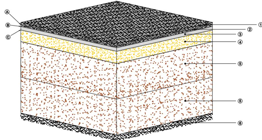
DETALLE "2" SECCION TIPO PAQUETE DE FIRME EN CALZADA SIN ESCALA
